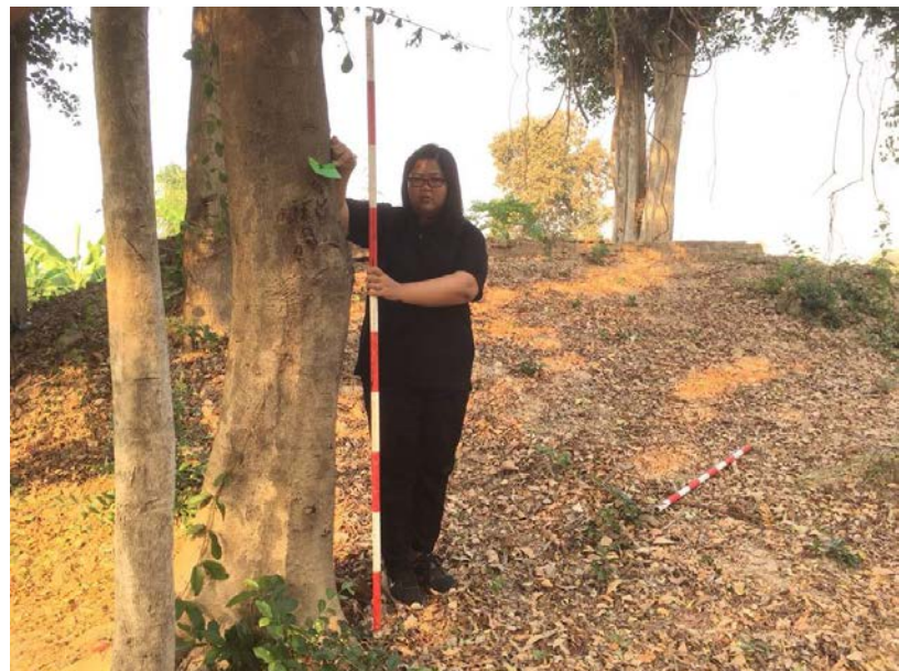
ภาพที่ 4 เส้นระดับสมมติ (Datum Line) ที่ระดับ 63.00 เมตร จากระดับน้ำทะเลปานกลาง ซึ่งมีค่าระดับสูงกว่าระดับอ้างอิง 2 เมตร (Datum Point = 61.00 เมตร)
